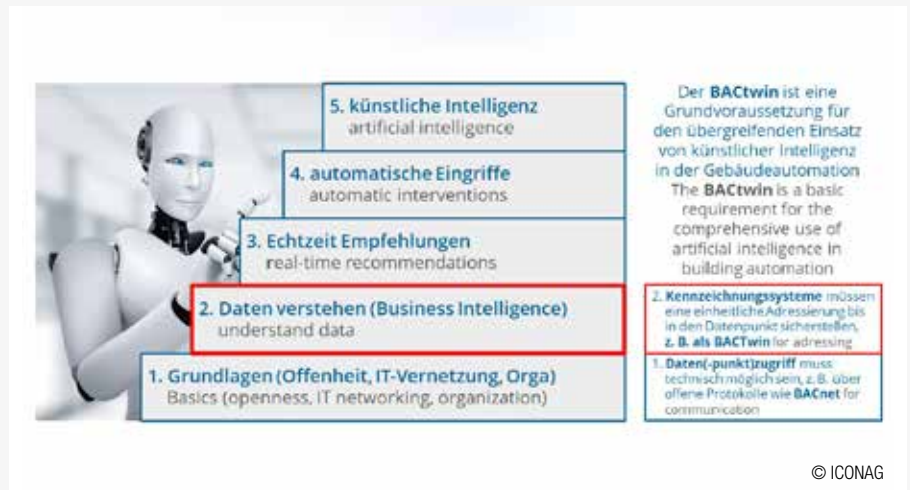
Die fünf Stufen zum Einsatz künstlicher Intelligenz in der Gebäudeautomation. The five steps to using artificial intelligence in building automation.
