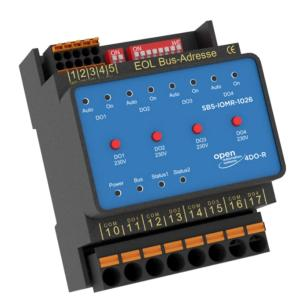
Das Digital-Ausgangs-Modul OAS-SBS-IOMR-1026 dient zur Ansteuerung von Lichtstromkreisen o.ä. Es bietet die Möglichkeit, über den **MODBus** empfangenen Schaltbefehle für die DOs mit Hilfe der Taster manuell zu übersteuern und somit eine sog. lokale Vorrangbedienung (LVB) zu realisieren. Die Relais-Ausgänge, die über Klemmen von der Karte abgegriffen werden, stellen jeweils den Schließerkontakt eines Relais zur Verfügung. Sie sind mit bistabilen Relais realisiert.
