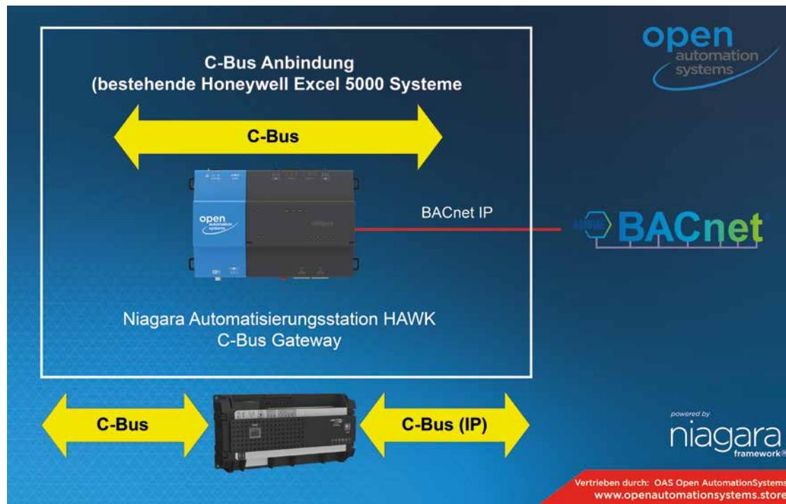
Entwickelt für die Integration von Honeywell-C-Bus-Anlagen in die offene Gebäudeautomation, sind die „BACnet Utilities“ ein nützliches Integrationswerkzeug aus dem Portfolio der OAS Open Automation Systems.
