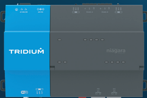
JACE® 8000 BACnet® Automationsplattform
