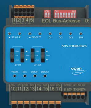
SBS IOM I/O-Serie Feldbusmodule
